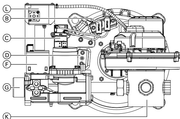
MatriX-Zylinderbrenner 120 bis 160 kW
