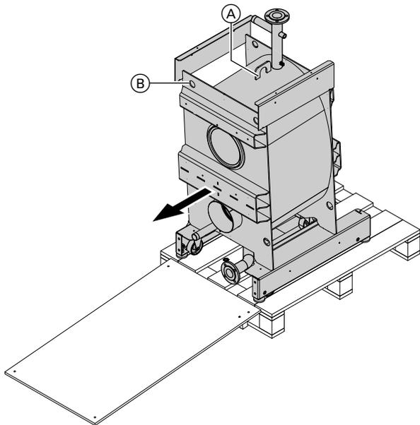
Der Heizkessel wird auf den Rollen rückwärts zum Standort gerollt. Das Einbringmaß entspricht daher der Kesselbreite von 680 mm.
